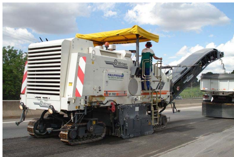
Fig. 4.1 Fresadora de pavimentos
