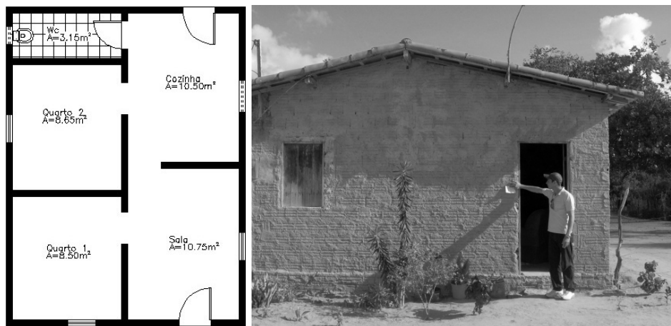
Figura 1 – Planta baixa e fachada frontal da edificação
